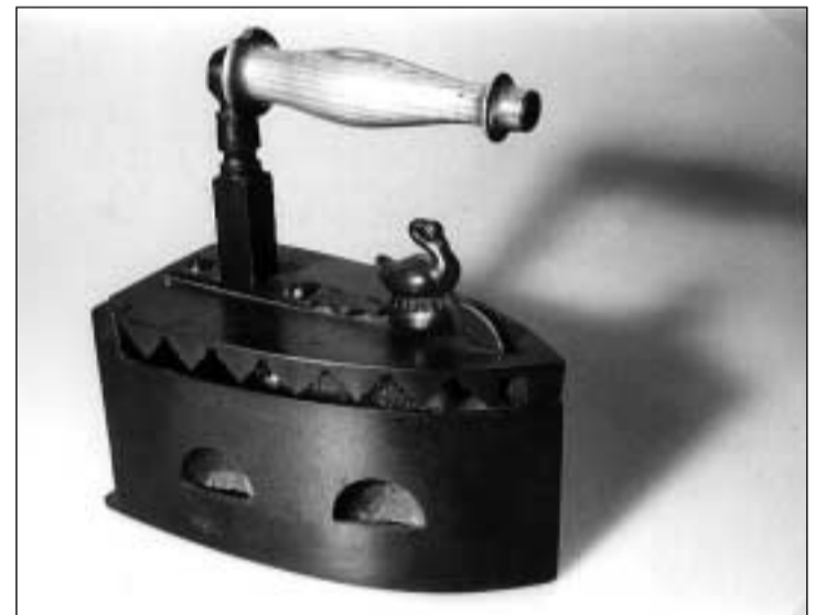
Fier da charvun u fier dad alv. Quest fier sumeglia ina pignina ambulanta. Per metter en ils charvuns ardents stuev' ins auzar il viertgel cul moni londervi.
